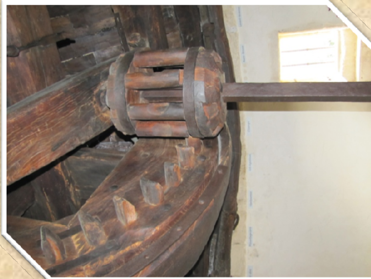
Engrenages en bois de la roue d'entraînement de la meule.
