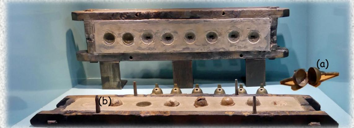
La petite bille d'acier permettant de faire tinter le grelot est placée au centre d'une balle de sable fortement compressé à l'aide de l'outil (a) puis cette balle est mise dans la demi-sphère du moule (b). Le moule est fermé (couvercle de la demi-sphère supérieure rabattu) et la coulée est effectuée. Après refroidissement, un passage sous l'eau permet de déliter le sable et libère la bille. Il ne reste plus qu'à finaliser le grelot.
