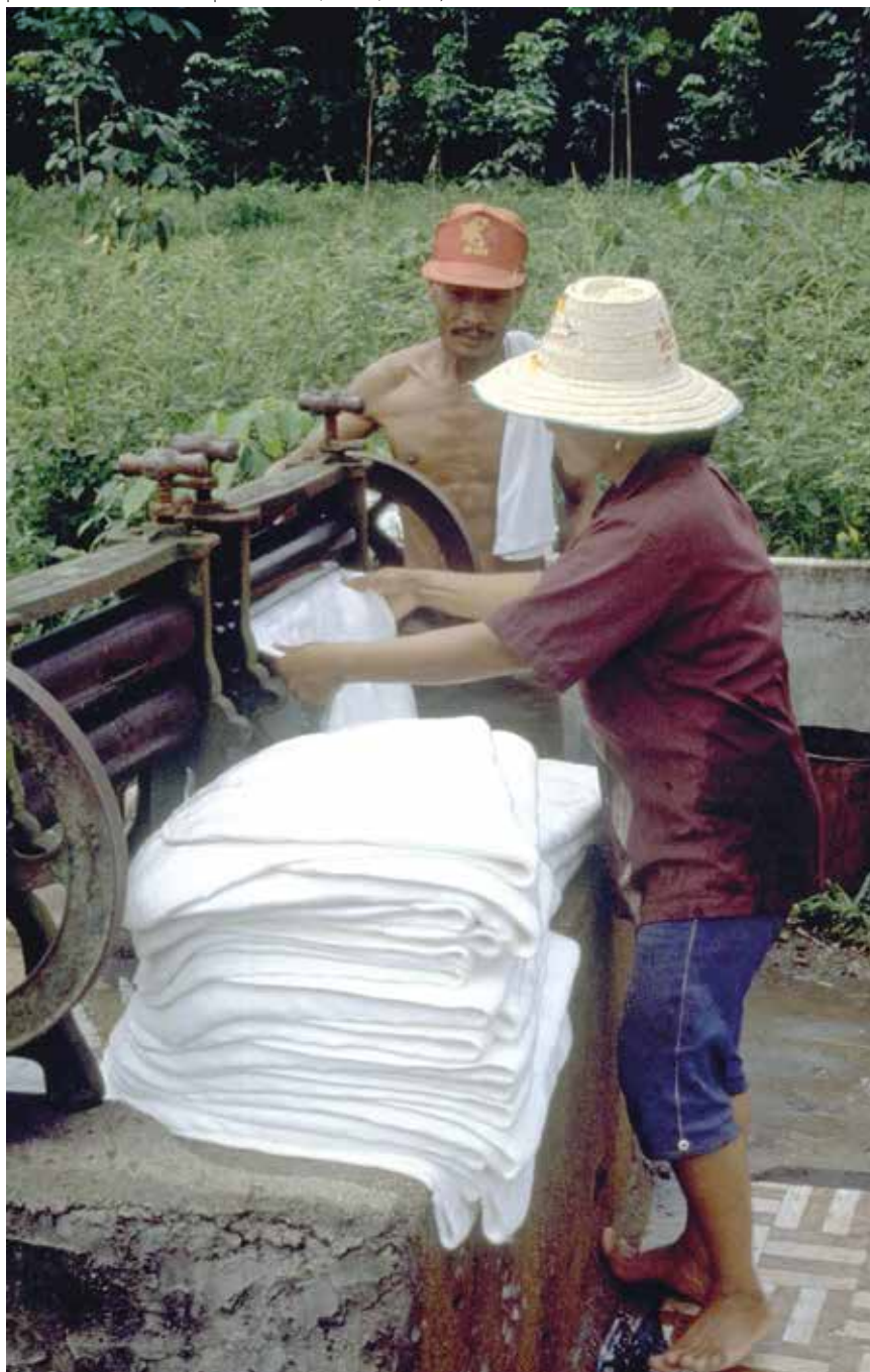
Presse de l'atelier de traitement du latex, essorage artisanal du latex pour la fabrication des feuilles de crêpe de caoutchouc (Thaïlande). © Inra - Guy Trébuil
